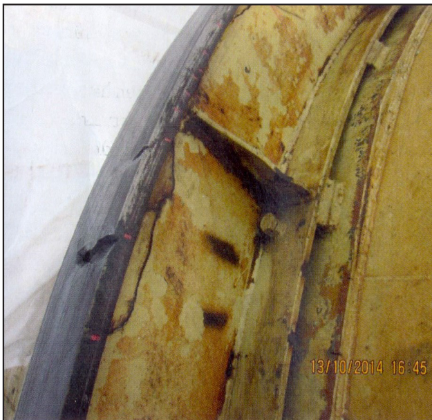
شکل ۱۴- خرابی چرخ دوار شستشو مقدماتی در کارخانه Klein Wanzleben
