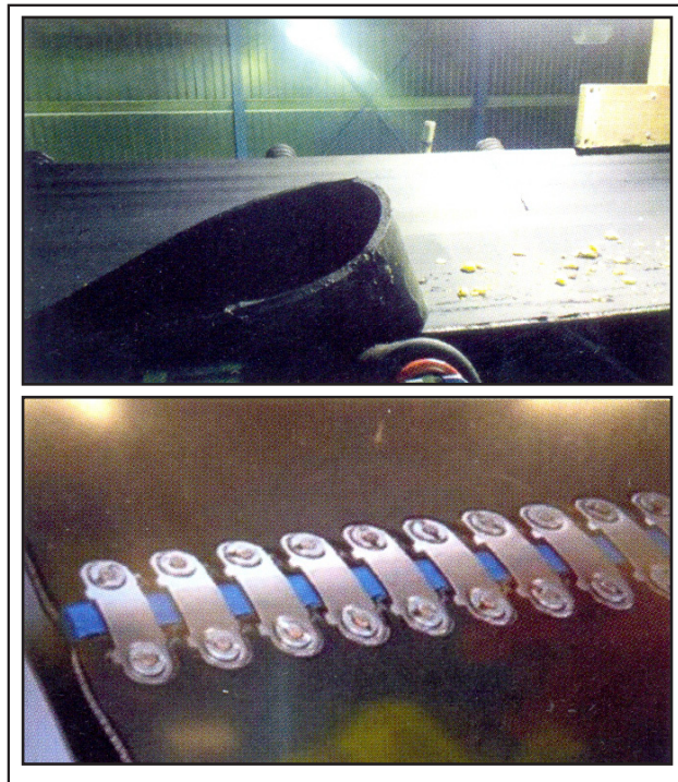
شکل ۱۳- تسمه پاره شده انتقال چغندر شستشو شده به بونکر چغندر
